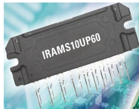
Рис. 1. Интеллектуальный модуль в корпусе SIP
