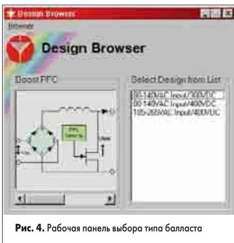
Рис. 4. Рабочая панель выбора типа балласта
